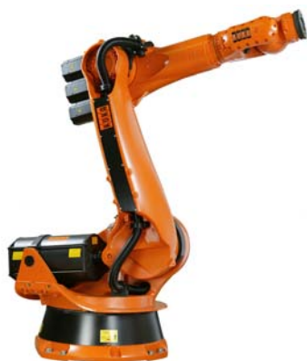
Bild 2: Ein „nackter“ Industrieroboter zählt zu den so genannten unvollständigen Maschinen. Für sie ist keine Konformitätserklärung nach Maschinenrichtlinie erforderlich, sondern eine Einbauerklärung (bisher Herstellererklärung). Bild: KUKA
